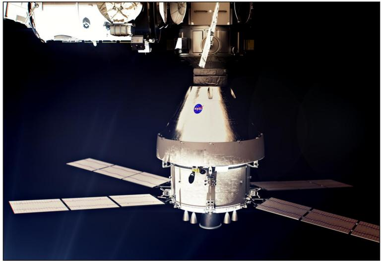
Das Raumschiff Orion, an der Mondstation Gateway andockt. Der untere Teil ist das Service-Modul, das von der Esa gestellt wird.
