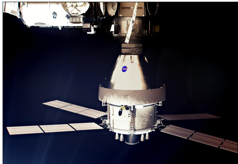
Das Raumschiff Orion, an der Mondstation Gateway andockt. Der untere Teil ist das Service-Modul, das von der Esa gestellt wird.
