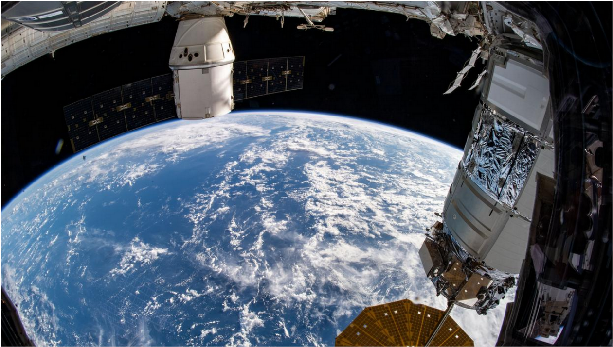
Die zwei US-amerikanischen Frachterttypen im Dezember 2019 gleichzeitig an der ISS angedockt: Hinten links die Dragon von SpaceX, vorne rechts die Cygnus von Northrop Grumman. Foto: Nasa
