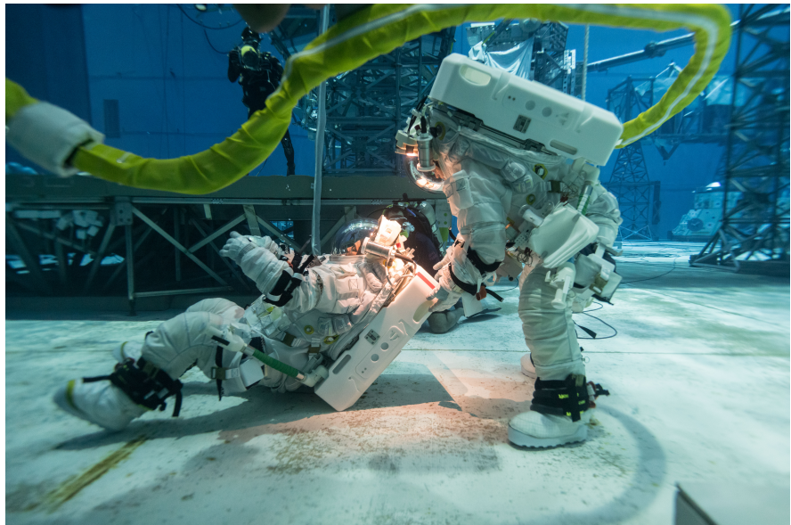
Die neuen Raumanzüge werden unter Wasser getestet, weil das die Schwerelosigkeit simuliert. Foto: Nasa
